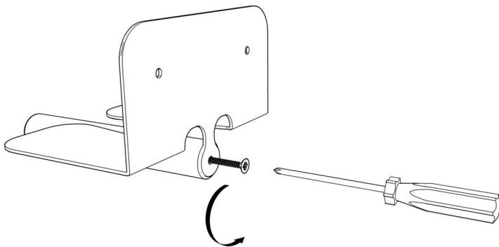
Metal parça ile ahşabı şekilde gösterildiği gibi vidalayınız.
